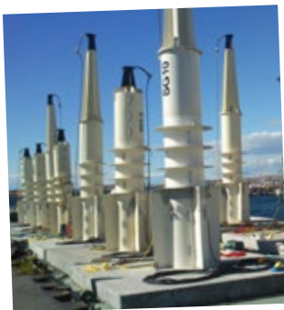
Vågenergiovandlare med linjärgeneratorer från Seabased .
