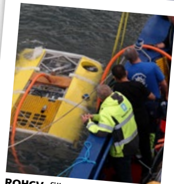
ROHCV , fjärrstyrd undervattensfarkost från Saab för miljövänlig tvätt av fartygsskrov utan dockbesök.
